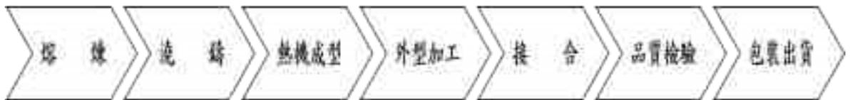
陶瓷靶材製造流程：
