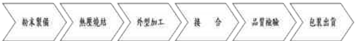
金屬蒸鍍材製造流程：
